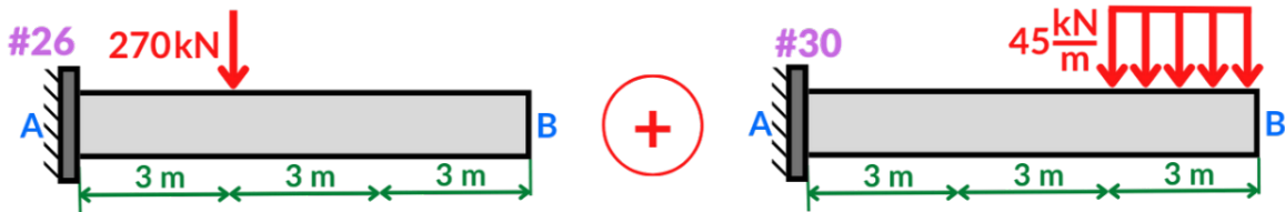
Figura 2.7 Aplicación de división de cargas según el método de superposición en viga empotrada.
