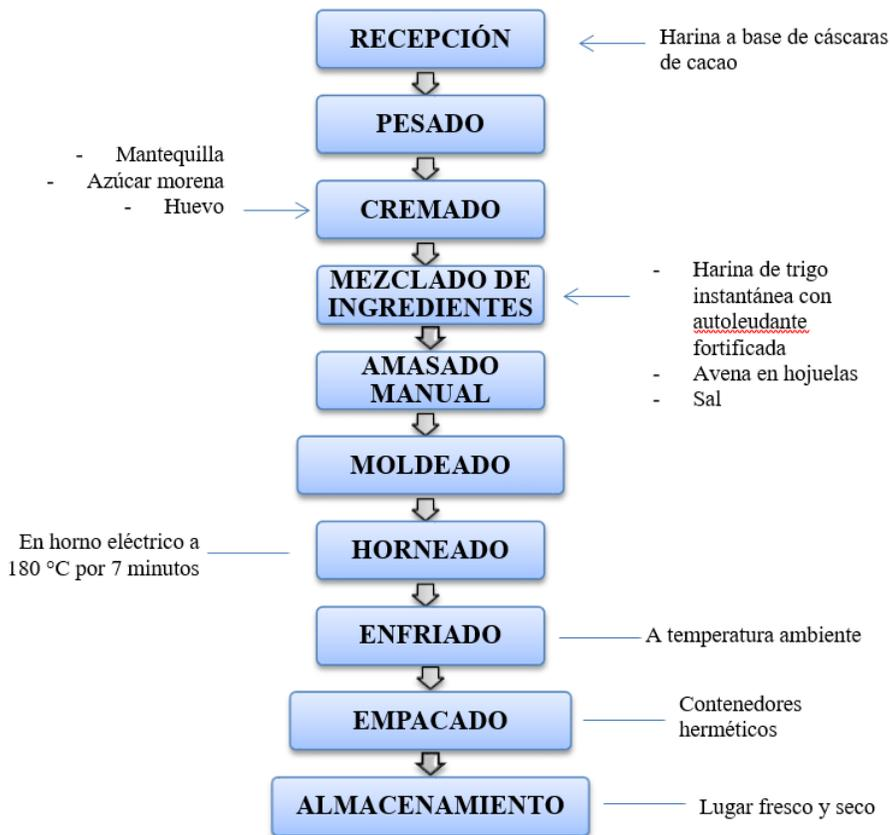
Figura 2: Diagrama de bloques del proceso para la elaboración de galletas de avena a base de harina de cáscaras de cacao
